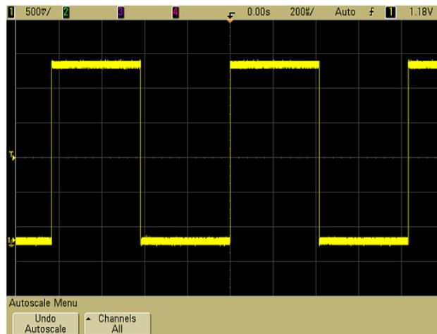
Wird bei dem Signal die Rechteckwelle nicht in der korrekten Form angezeigt, führen Sie die in [„Tastköpfe des Oszilloskops kompensieren“](#) auf Seite 38 beschriebenen Schritte durch.
