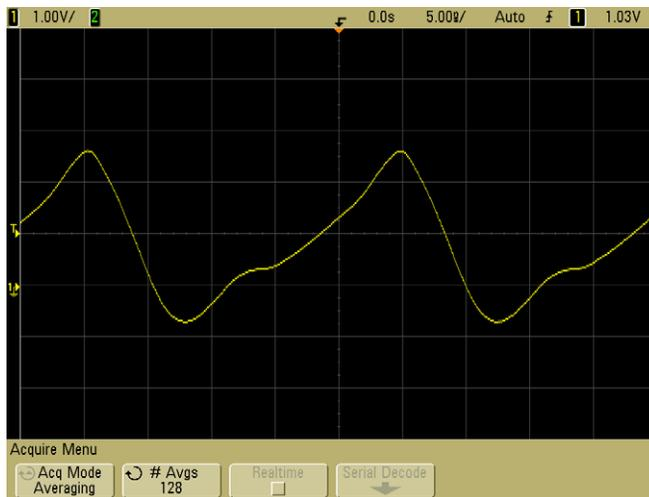
**Abbildung 39** 128 gemittelte Messungen zur Reduzierung von weißem Rauschen
